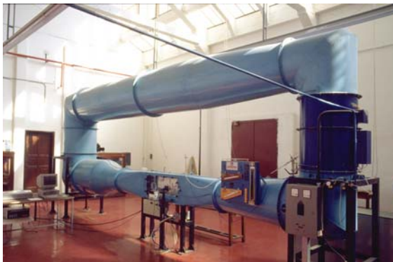
Galleria del vento
